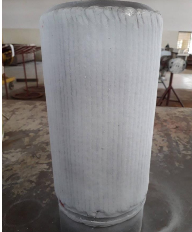
Overlay on Pipe OD using FCAW
